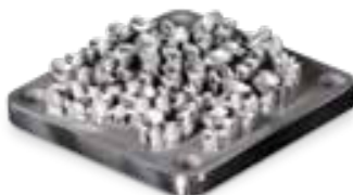
Produzione di parziali, cappette e ponti in LaserForm CoCr (C) Dental grade
